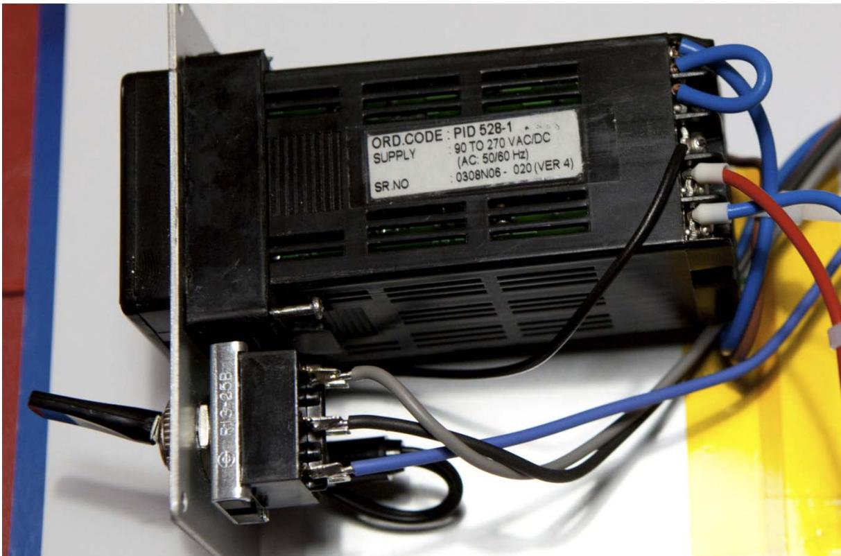
Merke die gelbe Isolierung an der Gehäusewand. Beim zusammengebauten Gehäuse liegt diese Stelle nah an den Klemmen vom PID. Die andere Wand hat genauso eine Isolierschicht bekommen. Das sind zwei bis drei Lagen je 1kV-festes Kapton.
