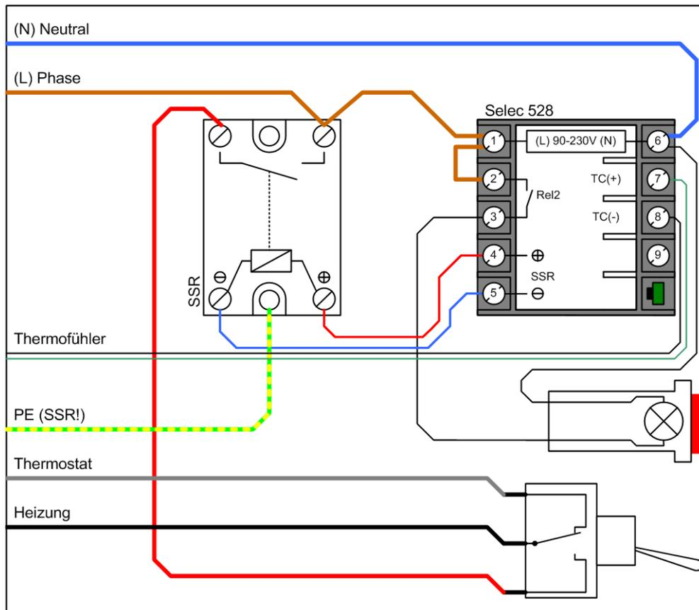
Eigentlich dürfte die Zeichnung selbsterklärend sein. Blau und Braun sind die 230V ~ Versorgungsspannung. Grau ist die von dem Gaggia-Thermostat gesteuerte 230V für die Heizung (Schwarz). Wenn der Schalter so steht, wie eingezeichnet, läuft die Gaggia mit eigener Temperaturregelung und die Box zeigt nur die Temperatur an. Legt man den Schalter um, wird über die rote Leitung 230V~ geschaltet vom SSR auf die Heizung gegeben und der PID hat die Kontrolle.
